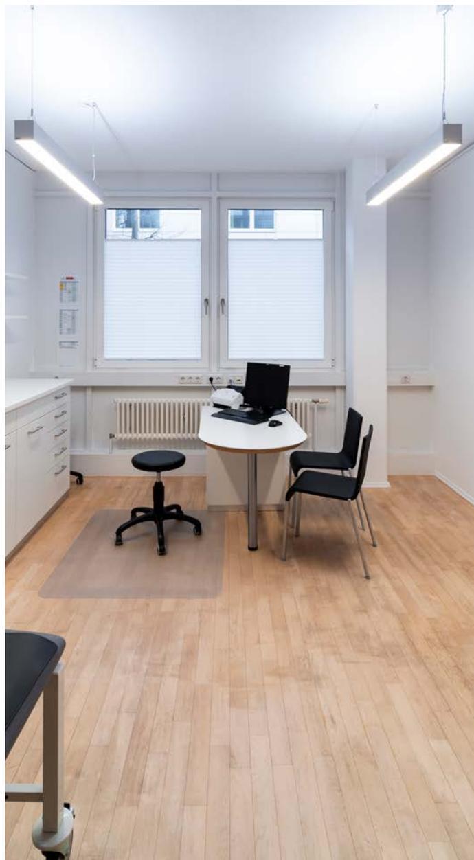
**Abb.:** In den Patientenzimmern steht aufgrund des Sichtschutzes an den Fenstern kaum Tageslicht zur Verfügung. Eine dynamische und intelligent gesteuerte Beleuchtungslösung passt ihre Farbtemperatur je nach Tageszeit zwischen 1800 K und 16.000 K an.
